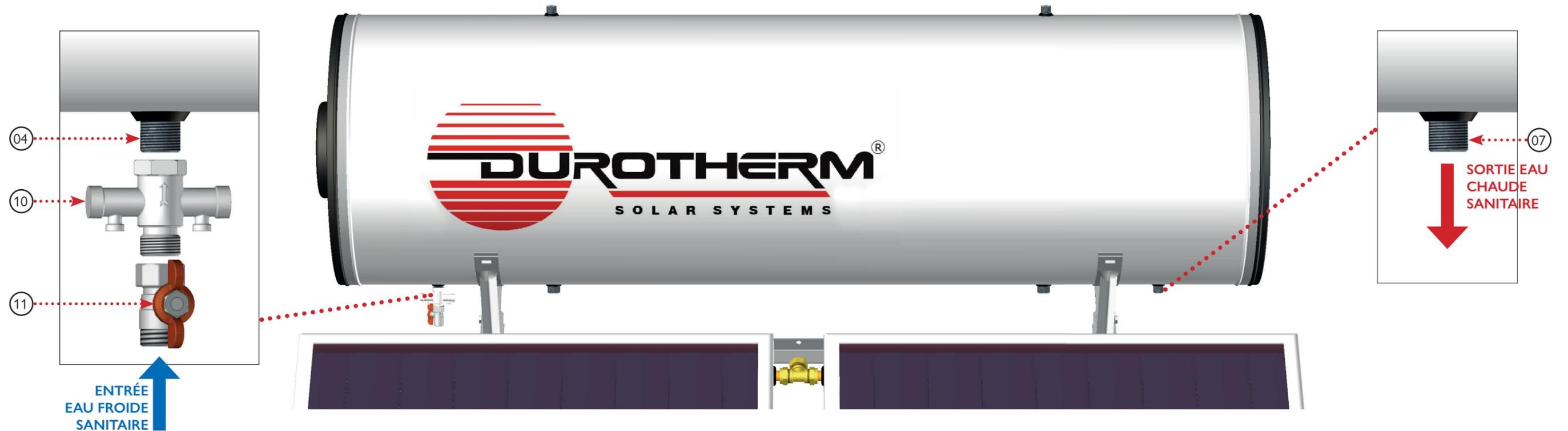
1. Visser le clapet anti-retour (10) sur le tube d'entrée de l'eau froide du ballon de stockage (04). Ce tube est marqué par une indication «**ENTRÉE EAU FROIDE**». Utiliser de la filasse pour assurer l'étanchéité.
